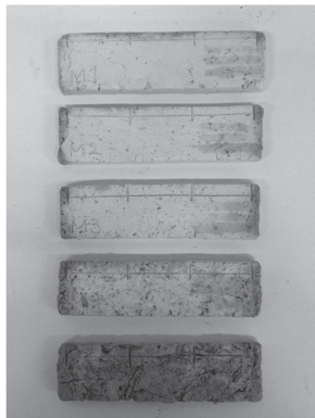
M1 | 信楽並土 (100)+もろみ (10) M2 | 信楽並土 (100)+もろみ (20) M3 | 信楽並土 (100)+もろみ (30) M4 | 信楽並土 (100)+もろみ (40) M5 | 信楽並土 (100)+もろみ (50)
