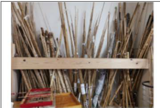
（写真2）工程1「伐り出し・晒し」工程 切り出してきた各種の竹を3ヶ月以上乾燥させて いる。
