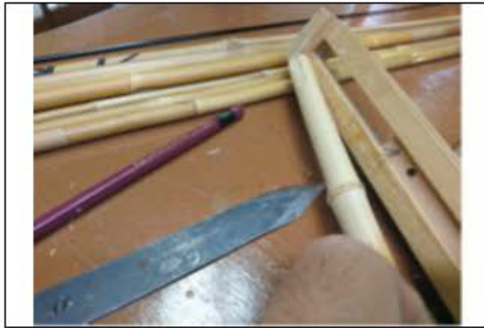
(写真7) 工程4「削り」継ぎ口の工作 継ぎ部分の皮を剥ぎ整形する
