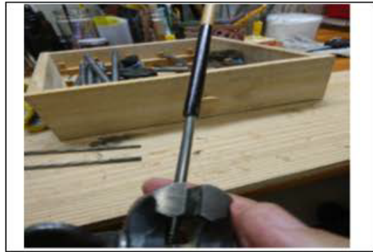
(写真10) 工程5「継ぎ」 継ぎ部分を棒ヤスリで整え、実際に継ぐ。
