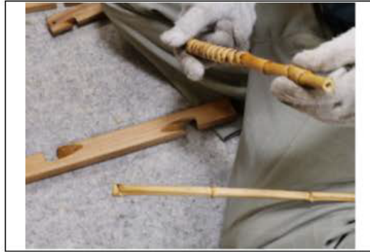
（写真4）（図版4）工程3「焼め・殺し」 竹を熱で柔らかくし、形や丸みを整える。
