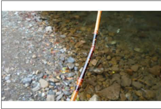
（写真19）「印籠作りの折損」
