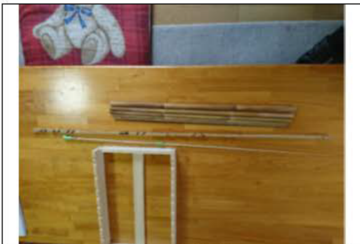
（写真3）工程2「切り組み」 乾燥させた竹を大まかに竿の長さに切る。
