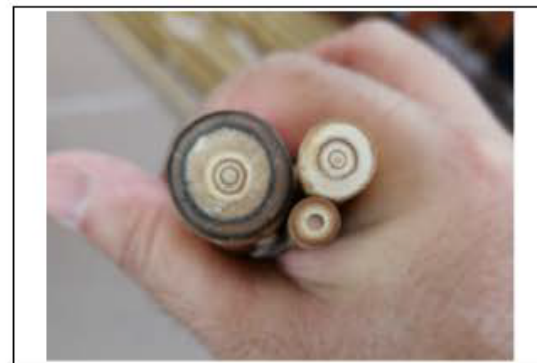
(写真12) 工程6「尾栓」 竿の各段の継ぎ側の穴を竹細工で閉じる。
