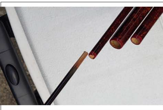
（写真21）「並継ぎの折損」
