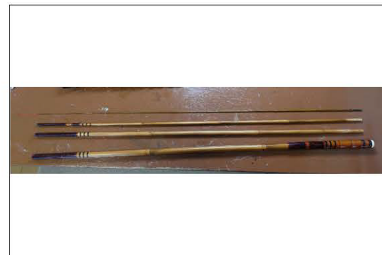
（写真18）「並継ぎ」 江戸和竿手法テンカラ竿 折り畳み85cm 全長3m30cm 竹、絹糸、漆、リリアン糸
