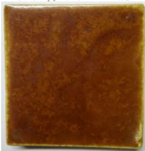
(図69) \text{Fe}_2\text{O}_3 6 % (1050℃—5 時間)
