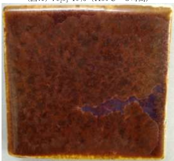
(図81) \text{Fe}_2\text{O}_3 10% (1050°C—5 時間)
