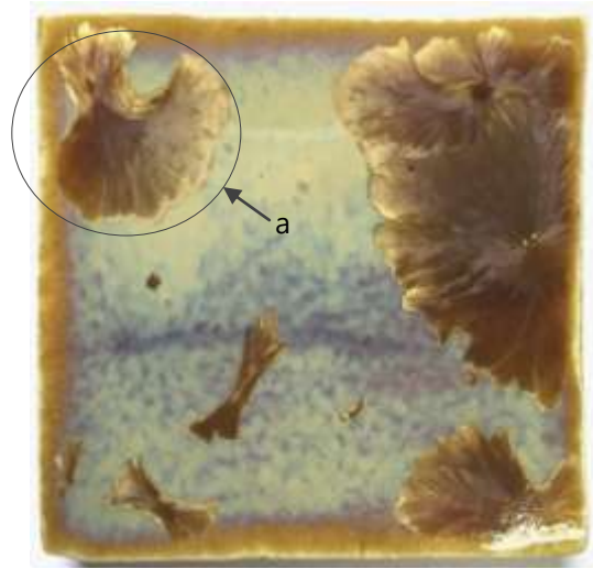
(図62) \text{Fe}_2\text{O}_3 4 % (1100°C—5 時間)
