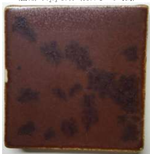
(図84) \text{Fe}_2\text{O}_3 15% (1050°C—5 時間)
