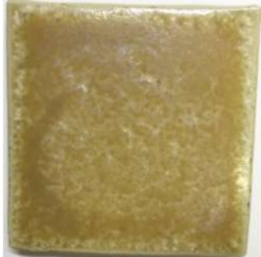
(図161) \text{Fe}_2\text{O}_3 1%、 \text{MnO} 1%(1100°C—5時間)
