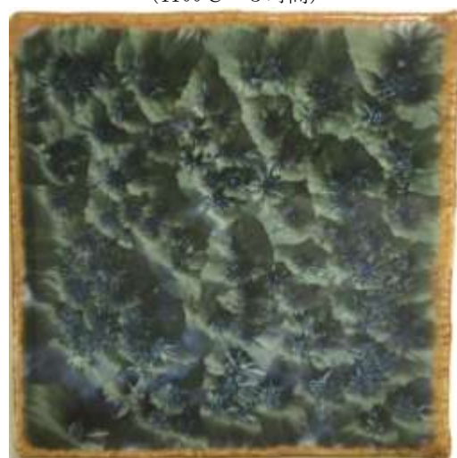
(図219) \text{Fe}_2\text{O}_3 2%、 \text{NiO}_2 1%、 \text{MnO} 2% (1100°C—5時間)
