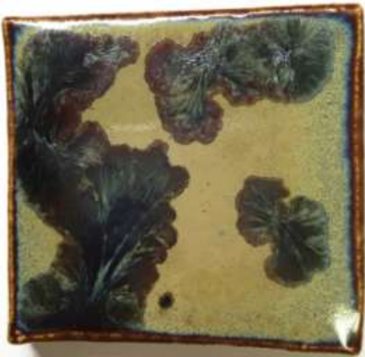
(図 213) \text{Fe}_2\text{O}_3 5 %、 \text{CuO} 1 %、 \text{NiO}_2 1 % (1100°C—5 時間)
