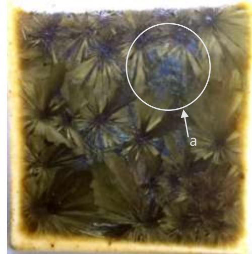
(図160) \text{Fe}_2\text{O}_3 2%、 \text{CuO} 2%(1100°C—5時間)
