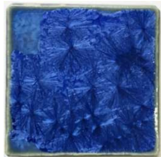
(図282) \text{MnO} 0.5%, \text{CuO} 1%, \text{Co}_3\text{O}_4 0.3% (1150°C 3時間—1050°C 3時間)
