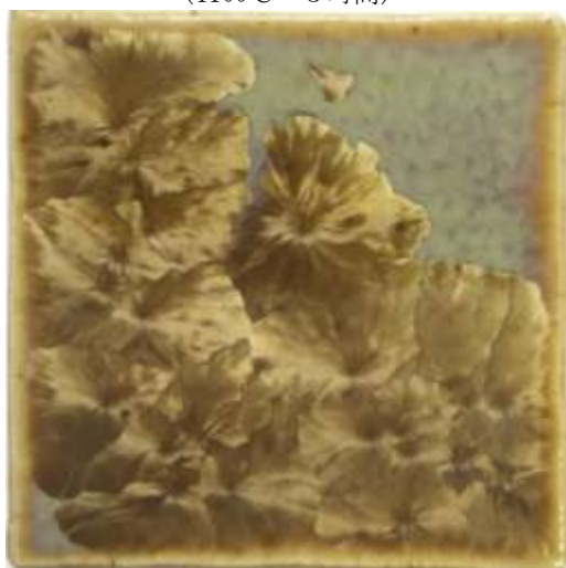
(図191) \text{Fe}_2\text{O}_3 2%、 \text{MnO} 1%、 \text{CuO} 1% (1100°C—5時間)
