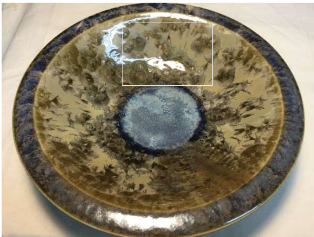
(図308) \text{Fe}_2\text{O}_3 2 %、 \text{MnO} 3 %、 \text{CuO} 1 % (1100℃ 3 時間－1150℃ 3 時間) 実施用
