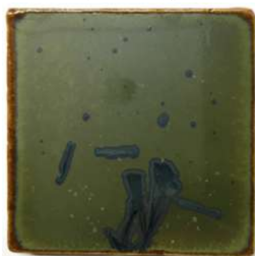
(図 208) \text{Fe}_2\text{O}_3 1%、 \text{CuO} 4%、 \text{NiO}_2 3% (1100°C—5時間)
