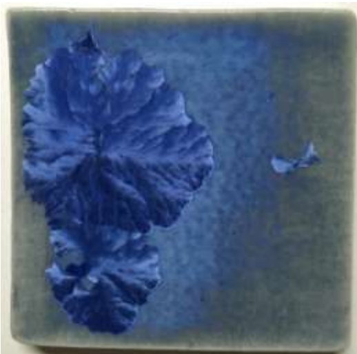
(図 238) \text{MnO} 0.5%, \text{CuO} 1%, \text{Co}_3\text{O}_4 0.3% (1100°C—5 時間)
