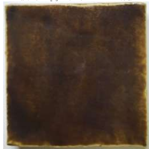
(図70) \text{Fe}_2\text{O}_3 7 % (1150℃—5 時間)
