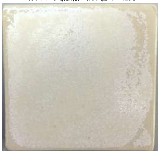
(図 9) 亜鉛結晶釉 酸化焼成 (1250度)
