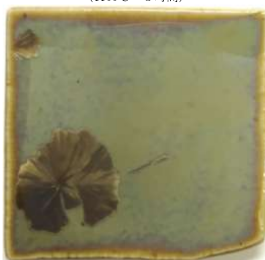
(図192) \text{Fe}_2\text{O}_3 2%、 \text{MnO} 1%、 \text{CuO} 2% (1100°C—5時間)
