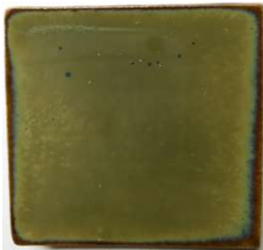
(図257) \text{Fe}_2\text{O}_3 1 %、 \text{CuO} 2 %、 \text{NiO}_2 3 % (1150°C 3 時間—1100°C 3 時間)
