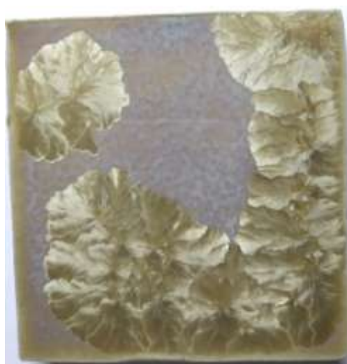
(図56) \text{Fe}_2\text{O}_3 2 % (1100°C—5 時間)
