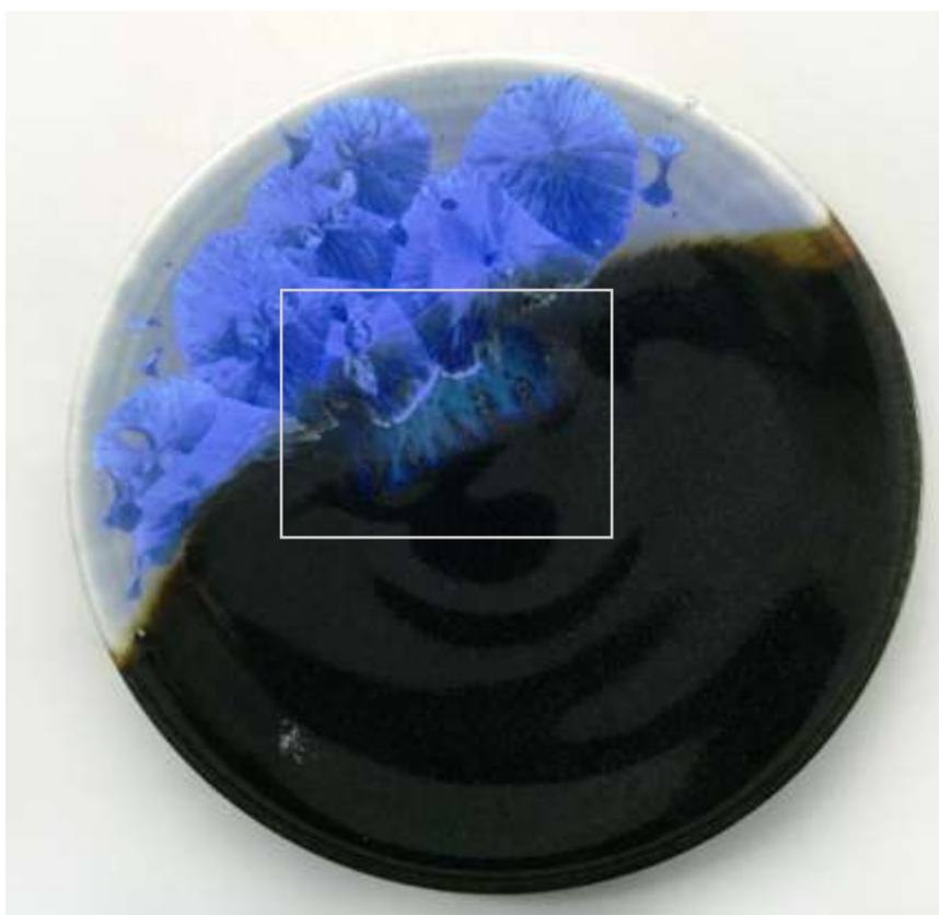
(図314) 亜鉛結晶釉 複合施釉② 実施用
