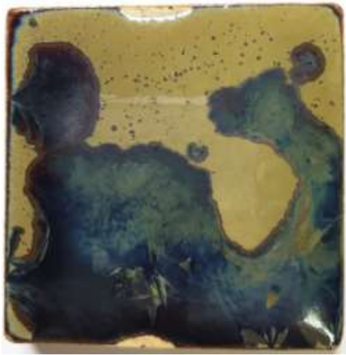
(図 211) \text{Fe}_2\text{O}_3 4 %、 \text{CuO} 1 %、 \text{NiO}_2 2 % (1100°C—5 時間)
