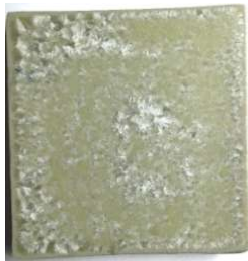
(図50) \text{Fe}_2\text{O}_3 0.5% (1100°C—5時間)
