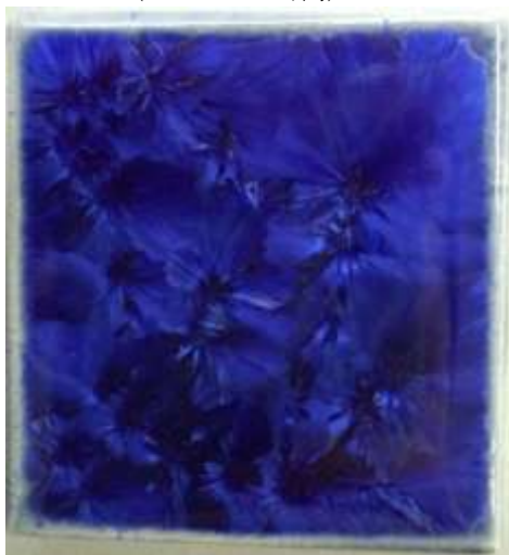
(図183) \text{MnO} 3%, \text{Co}_3\text{O}_4 1% (1100°C—5時間)
