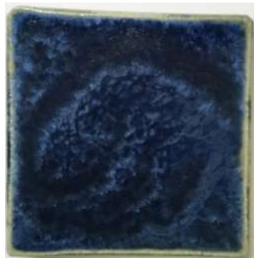
(図292) \text{Fe}_2\text{O}_3 1 %、 \text{MnO} 2 %、 \text{Co}_3\text{O}_4 0.3 % (1050°C 3 時間—1150°C 3 時間)
