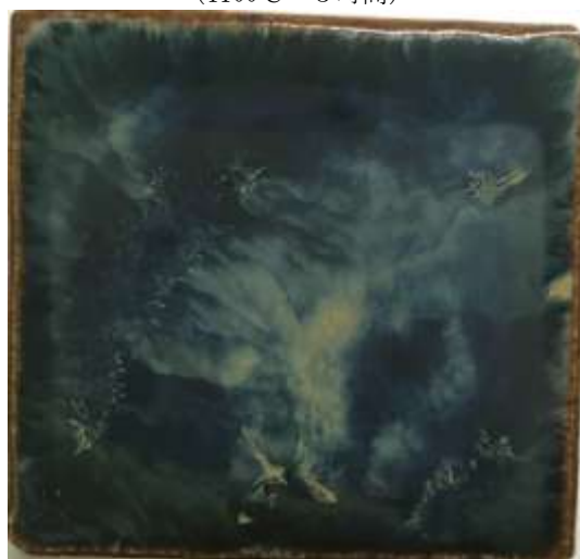
(図221) \text{Fe}_2\text{O}_3 2%、 \text{NiO}_2 2%、 \text{MnO} 2% (1100°C—5時間)
