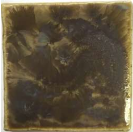
(図193) \text{Fe}_2\text{O}_3 2%、 \text{MnO} 2%、 \text{CuO} 1% (1100°C—5時間)
