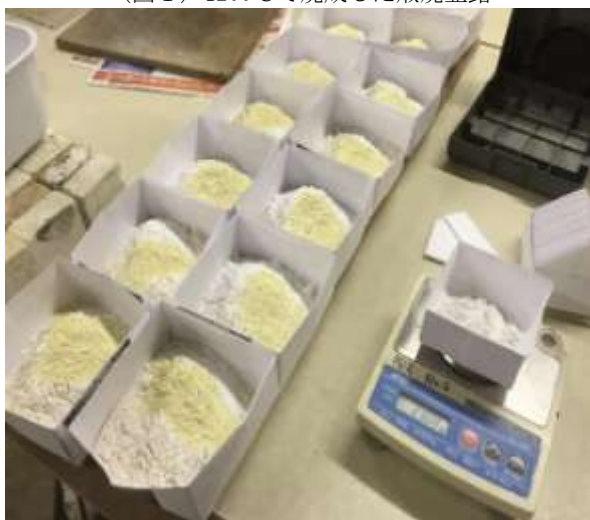
(図 3) 釉薬テストのため 100gづつ配合
