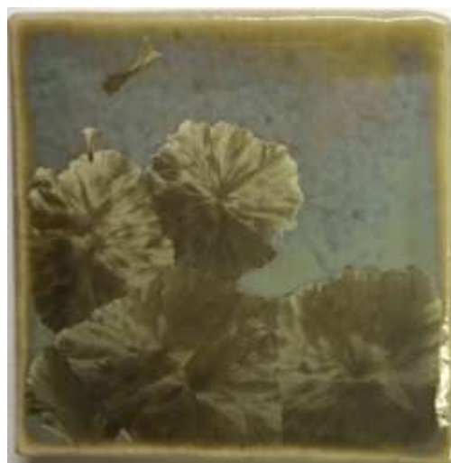
(図188) \text{Fe}_2\text{O}_3 1%、 \text{MnO} 1%、 \text{CuO} 2% (1100°C—5時間)
