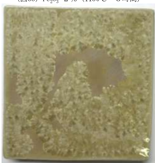
(図57) \text{Fe}_2\text{O}_3 2 % (1050°C—5 時間)
