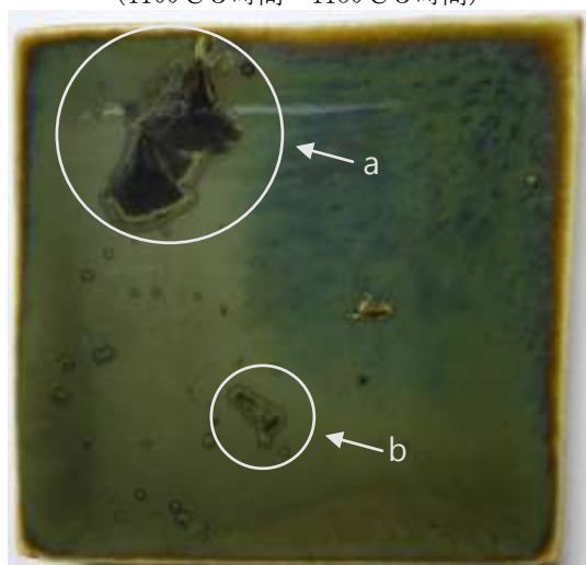
(図245) \text{Fe}_2\text{O}_3 2%, \text{MnO} 1%, \text{CuO} 3% (1150°C 3時間—1100°C 3時間)
