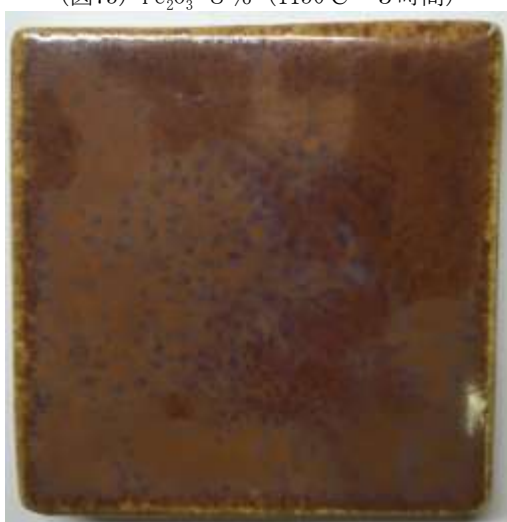
(図75) \text{Fe}_2\text{O}_3 8 % (1050°C—5 時間)
