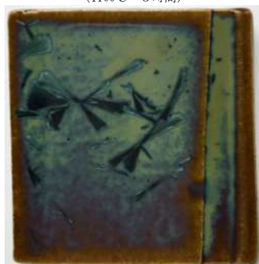
(図202) \text{Fe}_2\text{O}_3 1%、 \text{CuO} 2%、 \text{NiO}_2 2% (1100°C—5時間)
