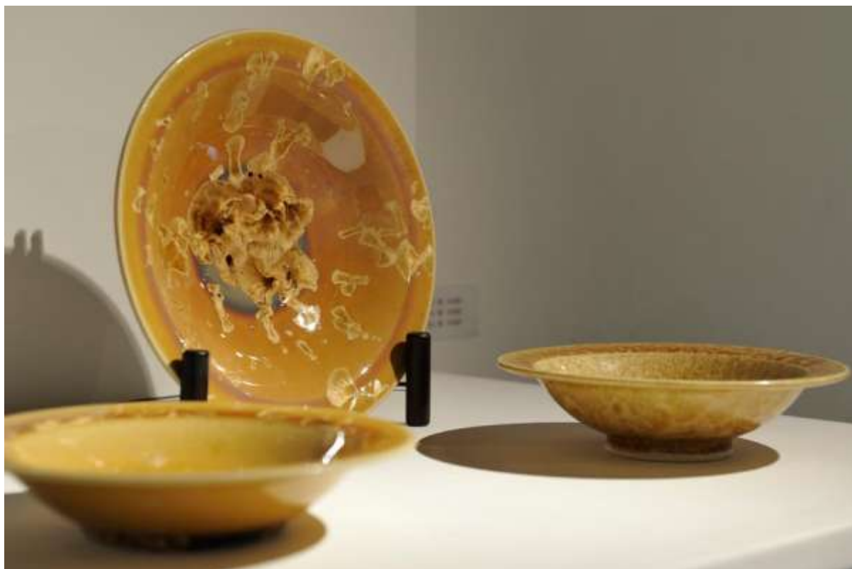
(図300) \text{Fe}_2\text{O}_3 2%、 \text{MnO} 2%添加 (1100°C 5時間) 実施用
