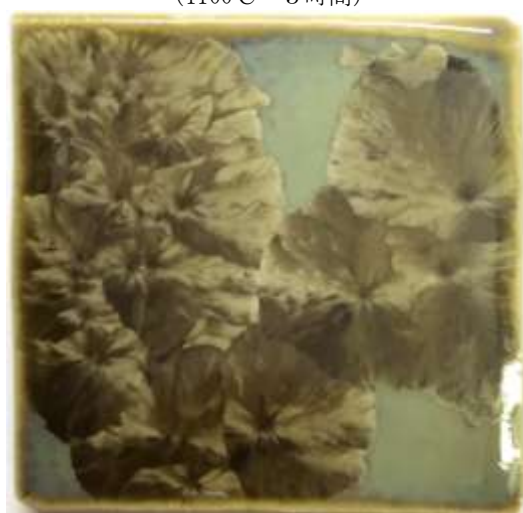
(図190) \text{Fe}_2\text{O}_3 1%、 \text{MnO} 2%、 \text{CuO} 2% (1100°C—5時間)
