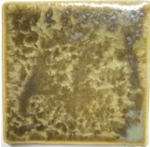
(図159) \text{Fe}_2\text{O}_3 2%、 \text{CuO} 1%(1100°C—5時間)
