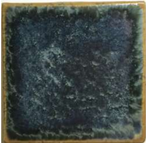
(図214) \text{Fe}_2\text{O}_3 1 %、 \text{NiO}_2 1 %、 \text{MnO} 1 % (1100°C—5 時間)
