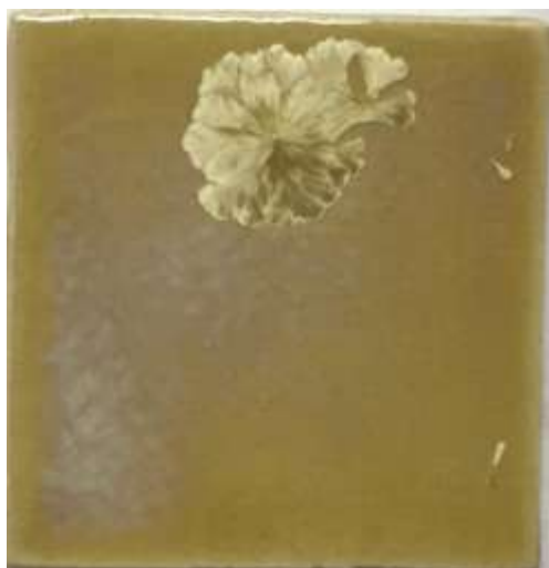
(図187) \text{Fe}_2\text{O}_3 1%、 \text{MnO} 1%、 \text{CuO} 1% (1100°C—5時間)
