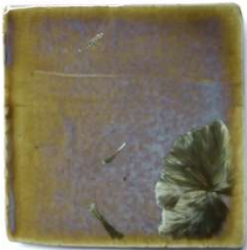
(図 233) \text{Fe}_2\text{O}_3 3%, \text{MnO} 1%, \text{Co}_3\text{O}_4 0.1% (1100°C—5 時間)
