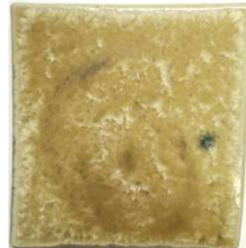
(図162) \text{Fe}_2\text{O}_3 1%、 \text{MnO} 2%(1100°C—5時間)
