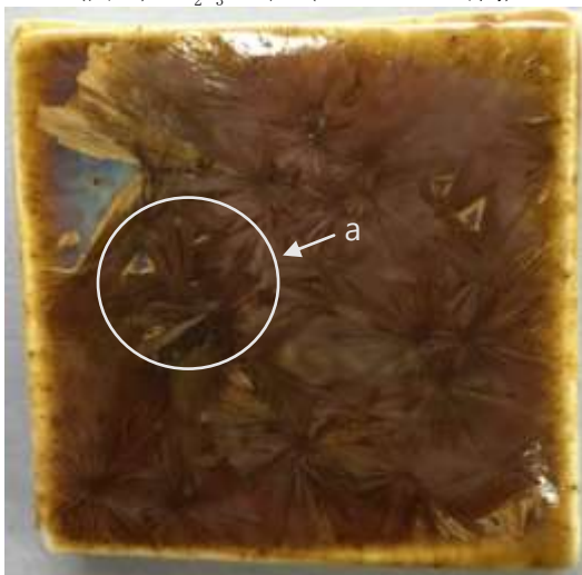
(図65) \text{Fe}_2\text{O}_3 5 % (1100°C—5 時間)
