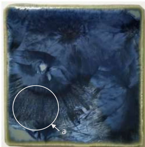
(図291) \text{Fe}_2\text{O}_3 1 %、 \text{MnO} 2 %、 \text{Co}_3\text{O}_4 0.3 % (1100°C 3 時間—1150°C 3 時間)
