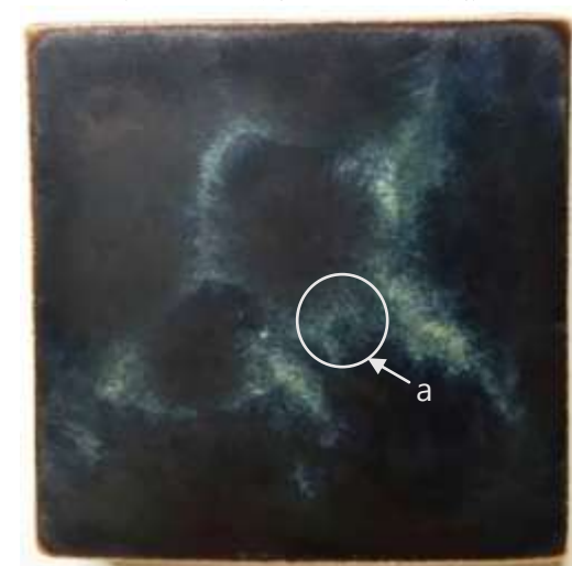
(図264) \text{Fe}_2\text{O}_3 4%, \text{CuO} 1%, \text{NiO}_2 2% (1050°C 3時間—1150°C 3時間)
