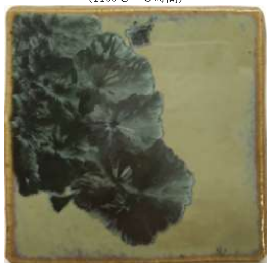
(図201) \text{Fe}_2\text{O}_3 1%、 \text{CuO} 2%、 \text{NiO}_2 1% (1100°C—5時間)
