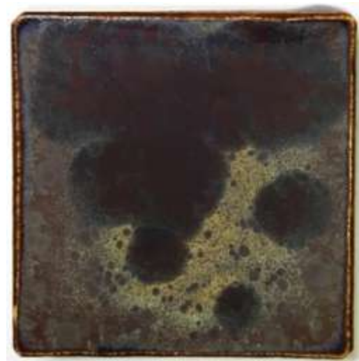
(図274) \text{Fe}_2\text{O}_3 5%, \text{CuO} 1%, \text{NiO}_2 1% (1150°C 3時間 - 1050°C 3時間)
