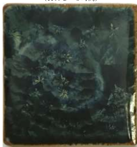
(図204) \text{Fe}_2\text{O}_3 2%、 \text{CuO} 1%、 \text{NiO}_2 2% (1100°C—5時間)
