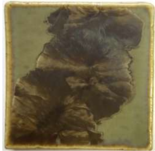
(図194) \text{Fe}_2\text{O}_3 2%、 \text{MnO} 2%、 \text{CuO} 2% (1100°C—5時間)
