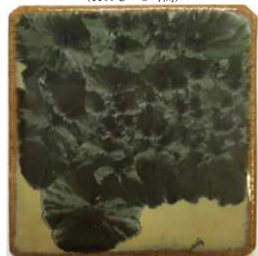
(図203) \text{Fe}_2\text{O}_3 2%、 \text{CuO} 1%、 \text{NiO}_2 1% (1100°C—5時間)
