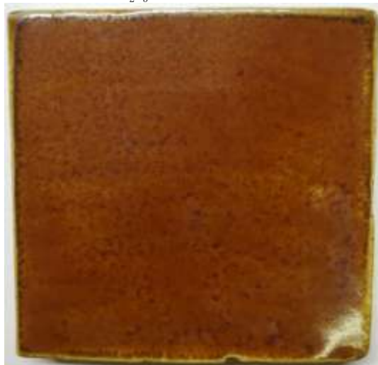
(図72) \text{Fe}_2\text{O}_3 7 % (1050℃—5 時間)
