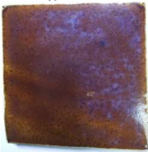
(図71) \text{Fe}_2\text{O}_3 7 % (1100℃—5 時間)
