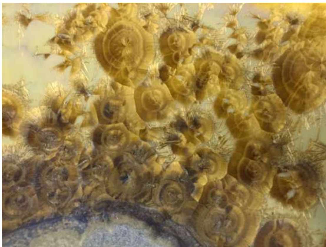
(図311) \text{Fe}_2\text{O}_3 2%、 \text{MnO} 1%、 \text{CuO} 2% (結晶成長温度 微調節) 実施用 拡大
