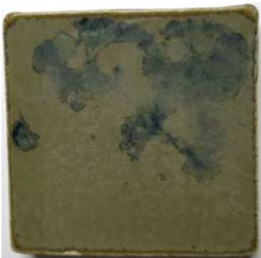
(図 235) \text{Fe}_2\text{O}_3 4%, \text{CuO} 1%, \text{Co}_3\text{O}_4 0.6% (1100°C—5 時間)
