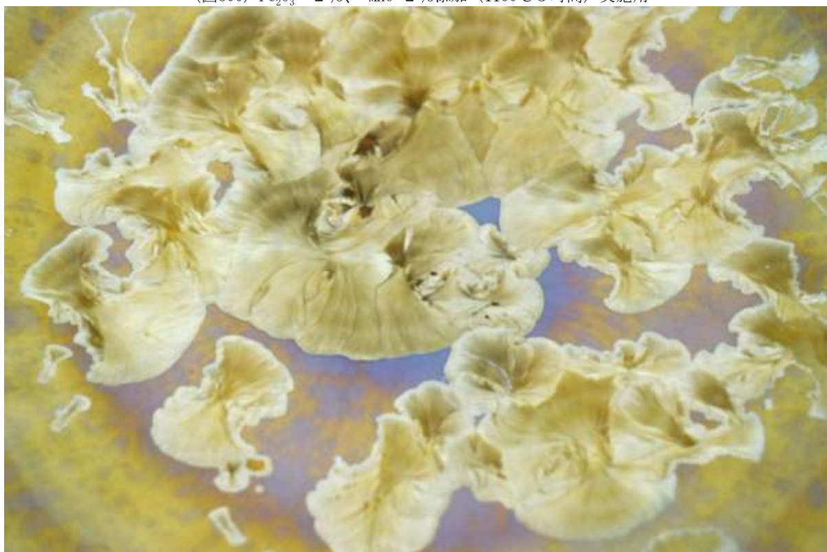
(図301) \text{Fe}_2\text{O}_3 2%、 \text{MnO} 2%添加 (1100°C 5時間) 実施用 拡大
