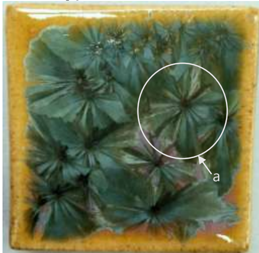
(図167) \text{Fe}_2\text{O}_3 2%、 \text{NiO}_2 1%(1100°C—5時間)
