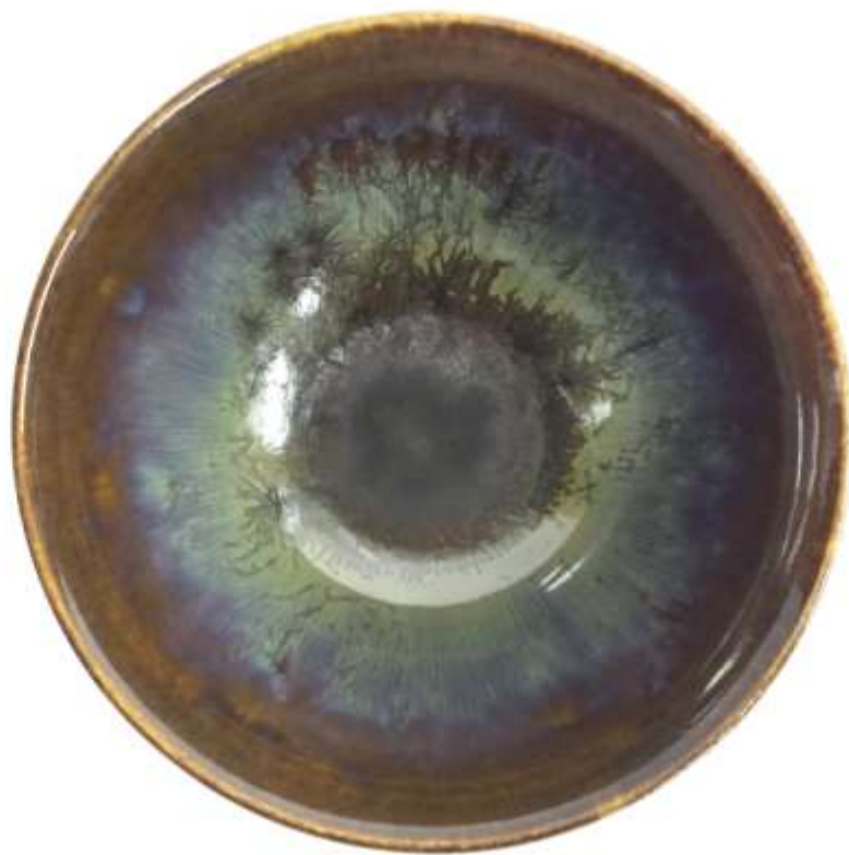
(図 304) \text{Fe}_2\text{O}_3 5 %、 \text{CuO} 1 %、 \text{NiO}_2 1 % (1150℃ 5 時間) 実施用
