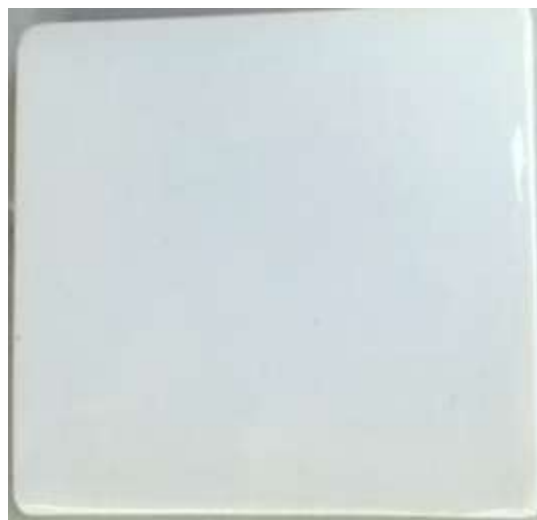
(図 8) 亜鉛結晶釉 還元焼成 (1250度)
