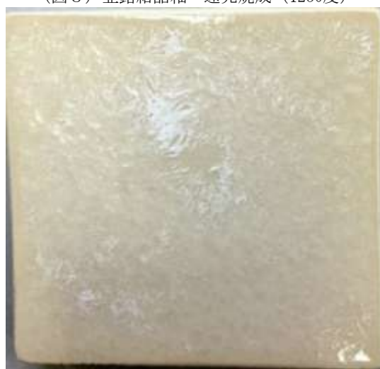
(図10) 亜鉛結晶釉 1150℃ (5時間)
