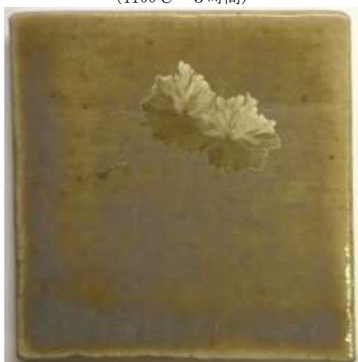
(図189) \text{Fe}_2\text{O}_3 1%、 \text{MnO} 2%、 \text{CuO} 1% (1100°C—5時間)
