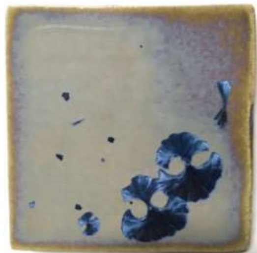
(図 237) \text{MnO} 3%, \text{NiO}_2 1%, \text{Co}_3\text{O}_4 0.2% (1100°C—5 時間)
