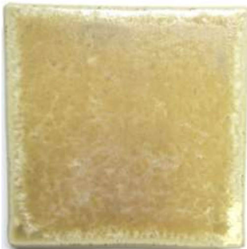
(図163) \text{Fe}_2\text{O}_3 2%、 \text{MnO} 1%(1100°C—5時間)
