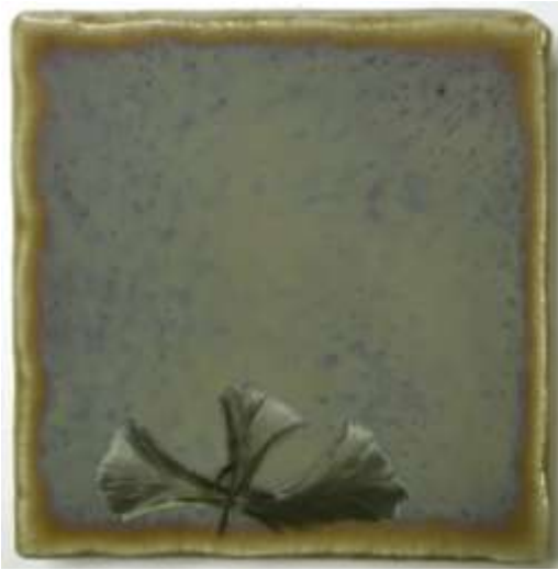
(図277) \text{Fe}_2\text{O}_3 2%, \text{MnO} 3%, \text{Co}_3\text{O}_4 0.1% (1150°C 3時間—1100°C 3時間)
