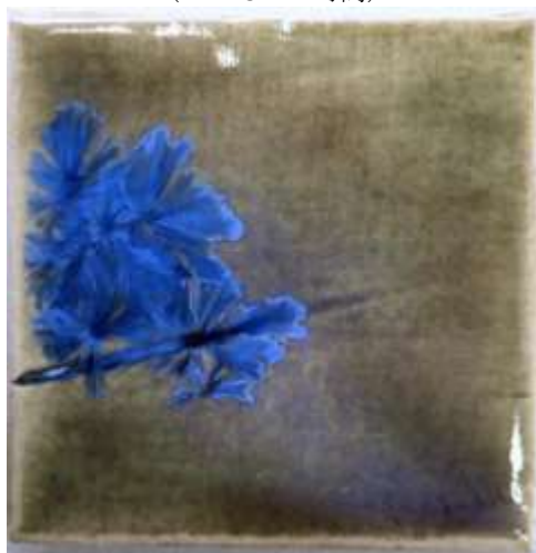
(図185) \text{NiO}_2 1%, \text{Co}_3\text{O}_4 0.3% (1100°C—5時間)
