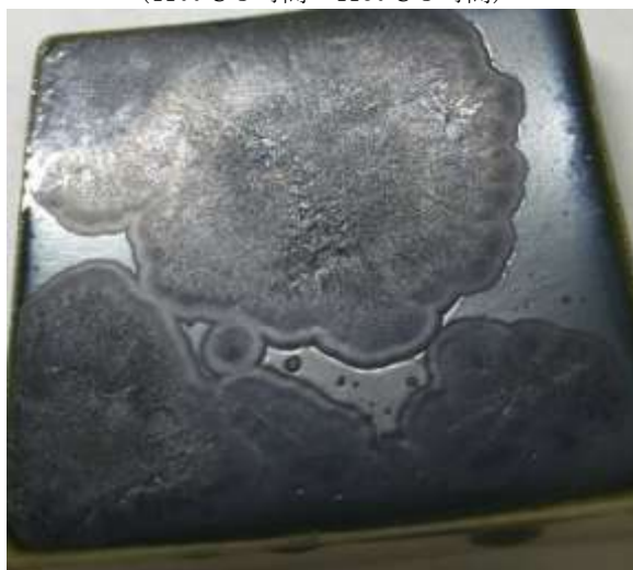
(図297) MnO 2%, CuO 8% (1050℃ 3時間 - 1150℃ 3時間) 拡大
