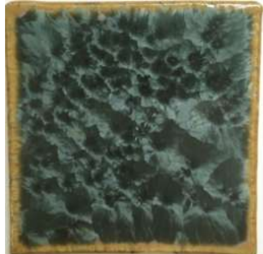
(図215) \text{Fe}_2\text{O}_3 1 %、 \text{NiO}_2 1 %、 \text{MnO} 2 % (1100°C—5 時間)
