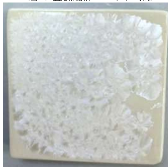
(図12) 亜鉛結晶釉 酸化焼成後 冷却酸化焼成
