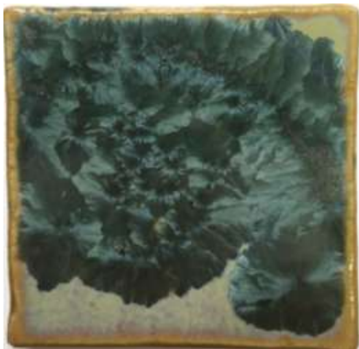
(図199) \text{Fe}_2\text{O}_3 1%、 \text{CuO} 1%、 \text{NiO}_2 1% (1100°C—5時間)
