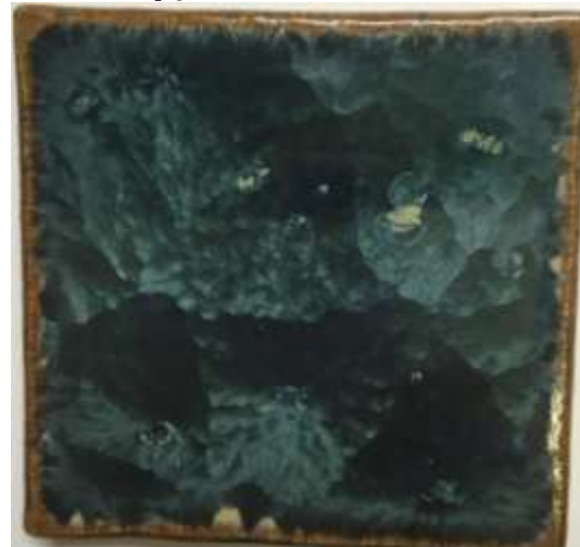
(図168) \text{Fe}_2\text{O}_3 2%、 \text{NiO}_2 2%(1100°C—5時間)
