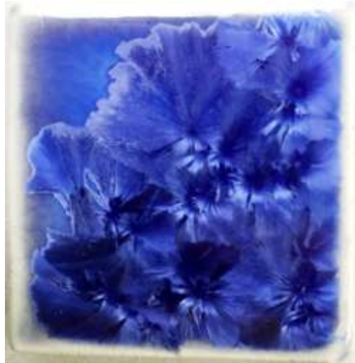
(図182) \text{MnO} 2%, \text{Co}_3\text{O}_4 0.3% (1100°C—5時間)
