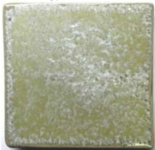
(図51) \text{Fe}_2\text{O}_3 0.5% (1050°C—5時間)
