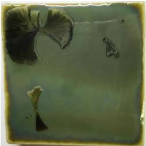
(図 197) \text{Fe}_2\text{O}_3 1%、 \text{MnO} 2%、 \text{CuO} 3% (1100°C—5時間)
