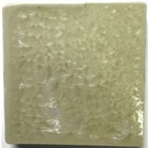
(図49) \text{Fe}_2\text{O}_3 0.5% (1150°C—5時間)
