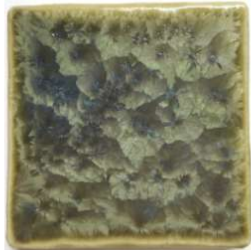
(図158) \text{Fe}_2\text{O}_3 1%、 \text{CuO} 2%(1100°C—5時間)
