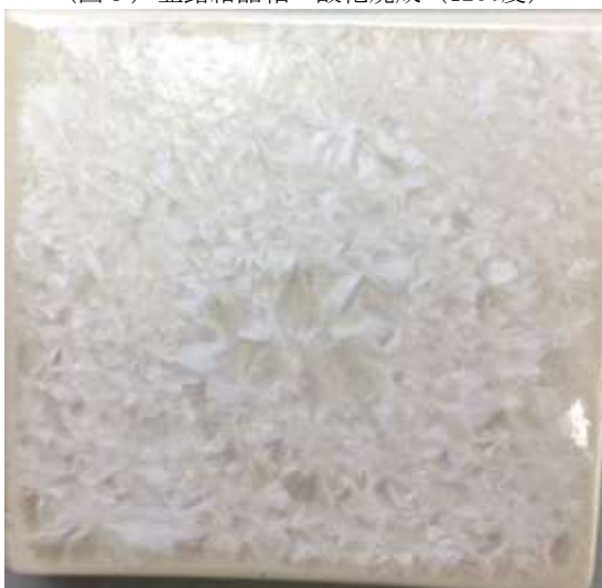
(図11) 亜鉛結晶釉 1100℃ (5時間)
