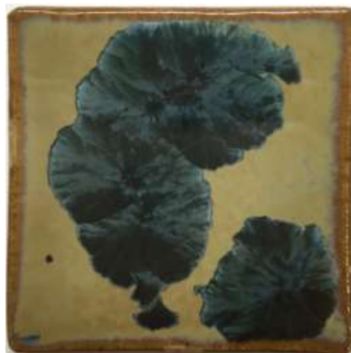
(図200) \text{Fe}_2\text{O}_3 1%、 \text{CuO} 1%、 \text{NiO}_2 2% (1100°C—5時間)
