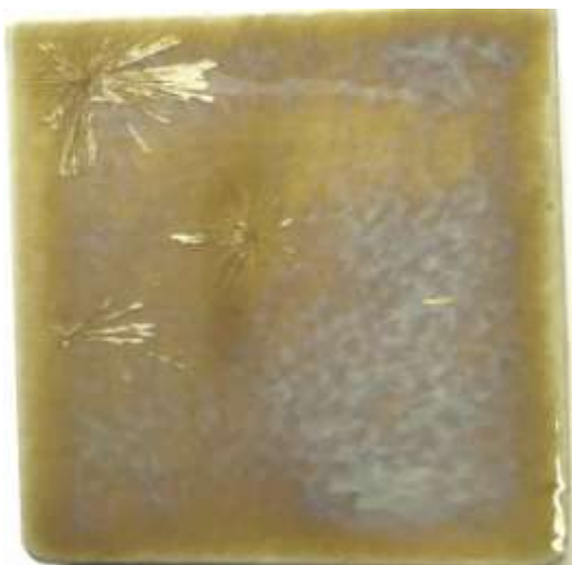
(図55) \text{Fe}_2\text{O}_3 2 % (1150°C—5 時間)
