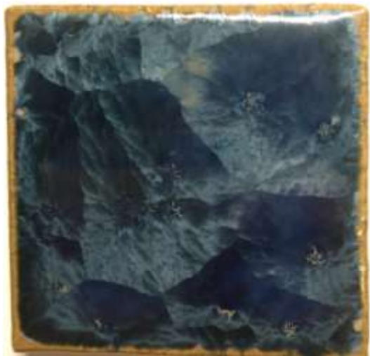
(図181) \text{MnO} 2%, \text{NiO}_2 2% (1100°C—5時間)
