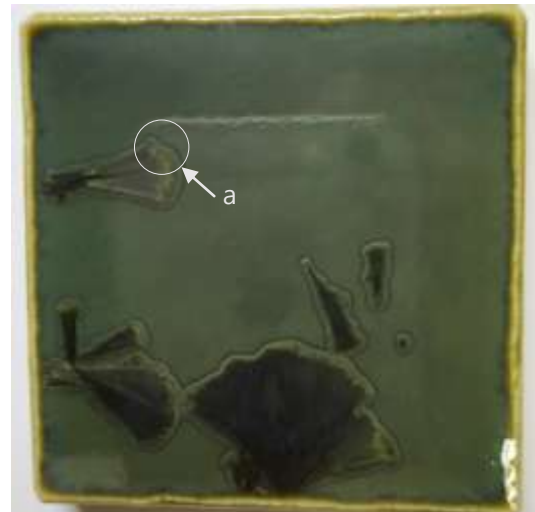
(図198) \text{Fe}_2\text{O}_3 1%、 \text{MnO} 2%、 \text{CuO} 4% (1100°C—5時間)
