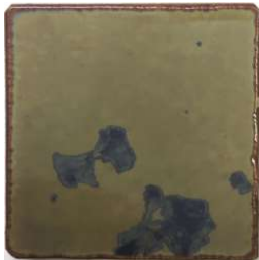
(図206) \text{Fe}_2\text{O}_3 2%、 \text{CuO} 2%、 \text{NiO}_2 2% (1100°C—5時間)
