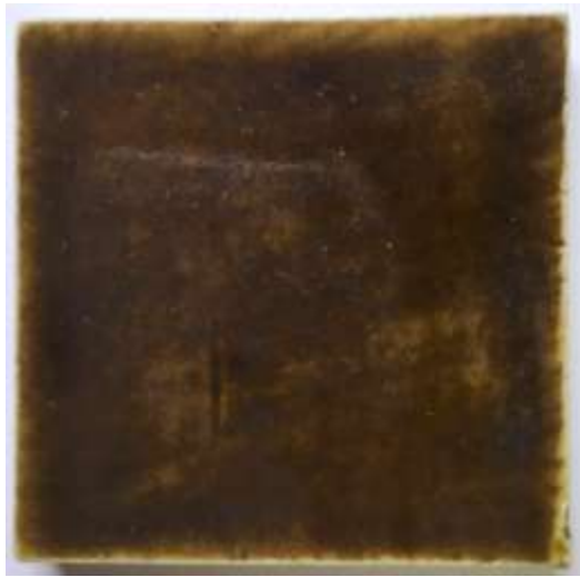
(図67) \text{Fe}_2\text{O}_3 6 % (1150℃—5 時間)
