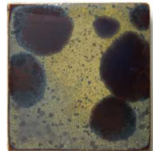
(図262) \text{Fe}_2\text{O}_3 4%, \text{CuO} 1%, \text{NiO}_2 2% (1150°C 3時間—1050°C 3時間)
