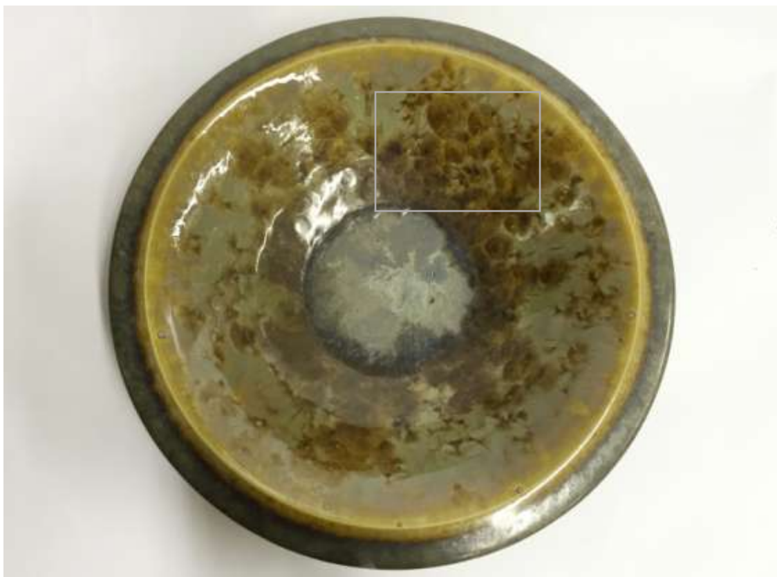
(図310) \text{Fe}_2\text{O}_3 2%、 \text{MnO} 1%、 \text{CuO} 2% (結晶成長温度 微調節) 実施用
