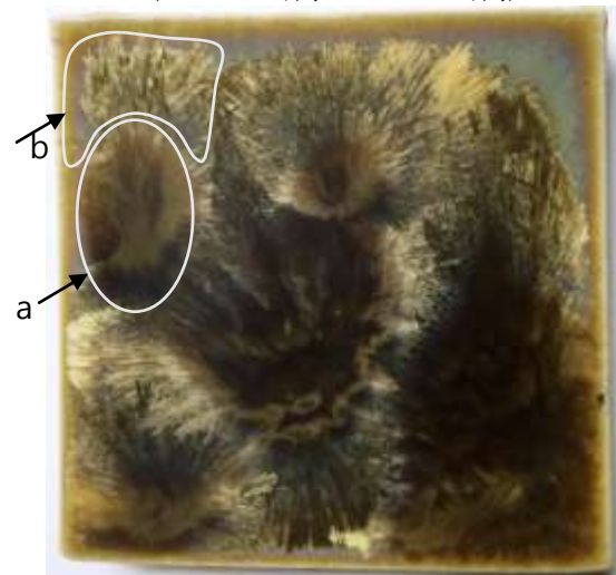
(図252) \text{Fe}_2\text{O}_3 2 %、 \text{MnO} 3 %、 \text{CuO} 1 % (1050°C 3 時間—1150°C 3 時間)
