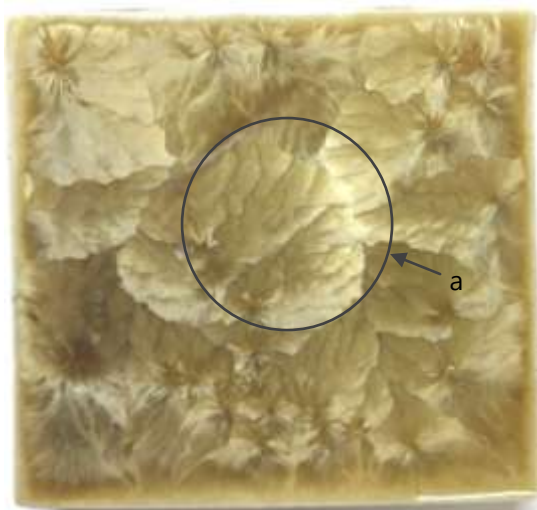
(図59) \text{Fe}_2\text{O}_3 3 % (1100°C—5 時間)
