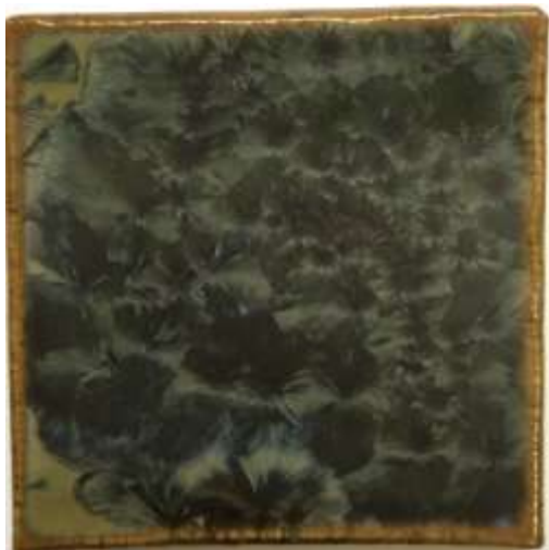
(図205) \text{Fe}_2\text{O}_3 2%、 \text{CuO} 2%、 \text{NiO}_2 1% (1100°C—5時間)
