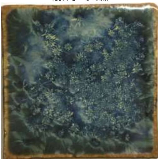
(図218) \text{Fe}_2\text{O}_3 2%、 \text{NiO}_2 1%、 \text{MnO} 1% (1100°C—5時間)
