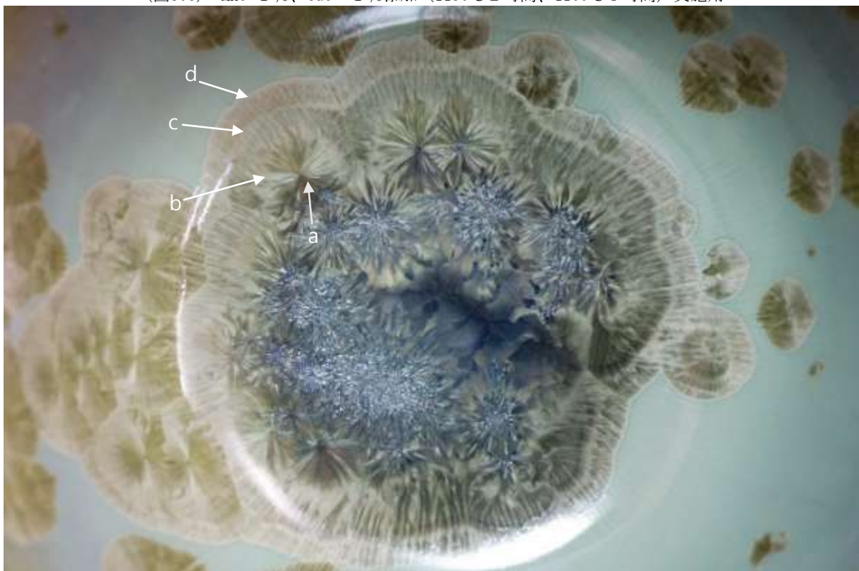
(図307) MnO 1%、CuO 1%添加 (1150℃ 2時間、1100℃ 3時間) 実施用 拡大
