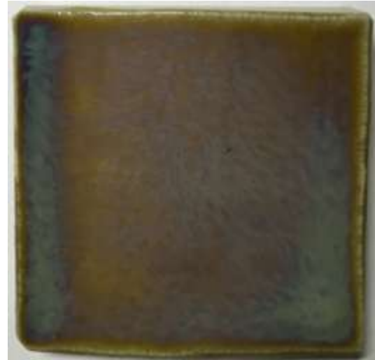
(図280) \text{Fe}_2\text{O}_3 2%, \text{MnO} 3%, \text{Co}_3\text{O}_4 0.1% (1050°C 3時間—1150°C 3時間)
