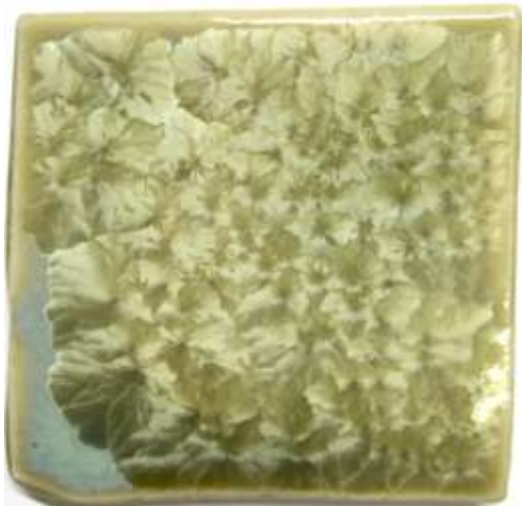
(図157) \text{Fe}_2\text{O}_3 1%、 \text{CuO} 1%(1100°C—5時間)
