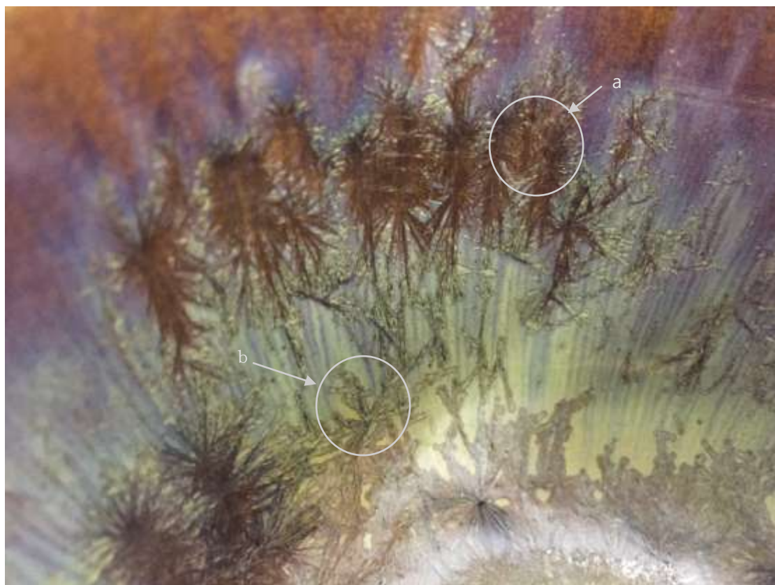
(図305) \text{Fe}_2\text{O}_3 5 %、 \text{CuO} 1 %、 \text{NiO}_2 1 % (1150℃ 5 時間) 実施用 拡大
