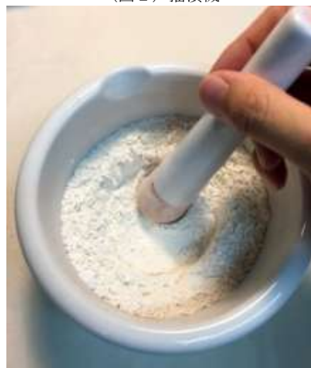
(図 4) 配合した釉薬を乳鉢に入れ混合
