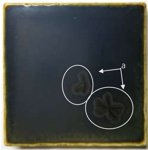
(図271) \text{Fe}_2\text{O}_3 3%, \text{MnO} 1%, \text{CuO} 5% (1100°C 3時間 - 1150°C 3時間)
