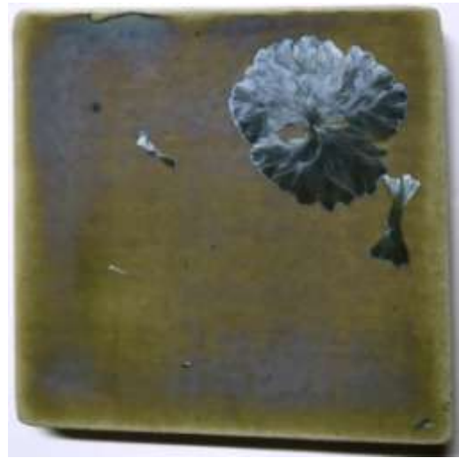
(図 234) \text{Fe}_2\text{O}_3 1%, \text{CuO} 2%, \text{Co}_3\text{O}_4 0.1% (1100°C—5 時間)
