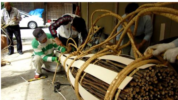
写真 24 : 先輩が結えるのを見て若衆が結び方を覚える。 後方では、長老が次の作業に必要な藤の根の 良し悪しを選んでいる。
