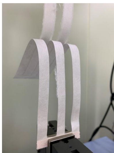
写真 16 引っ張り強度試験の様子
