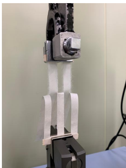
写真 15 引っ張り強度試験の様子
