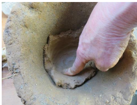
(図版 17-⑧) 内側に絶縁体になる細かい砂をつけ、底から粘土を張り付けていく。2018 年 5 月 20 日
