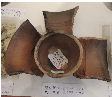
(図版 6-⑤) 土器の使用耐久実験結果による割れた土器 漏水時間 220 時間：使用回数 25 回
