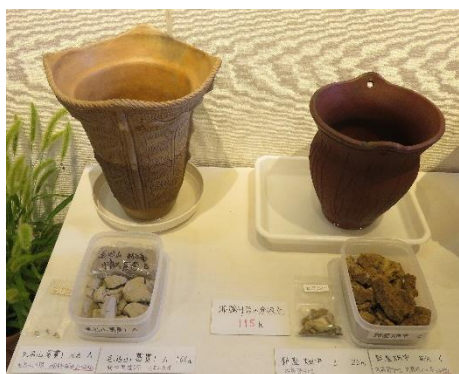
(図版 6-④) 水漏れ実験の様子 土器に水を 1 リットル入れ、漏水時間を計測。 漏水時間が 115 時間より上ものは煮炊き可能。
