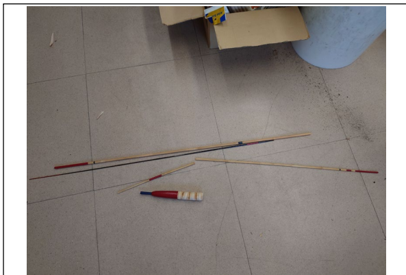
(写真2) フライロッドのキャストに近い5kgの荷重をかけたところ折れた和竿
