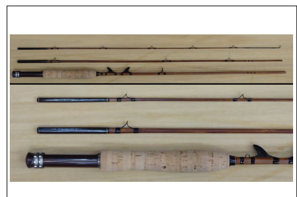
(写真6) 煤竹を使った六角竿の例(「煤竹テンカラフライロッド」筆者作 2022年)
